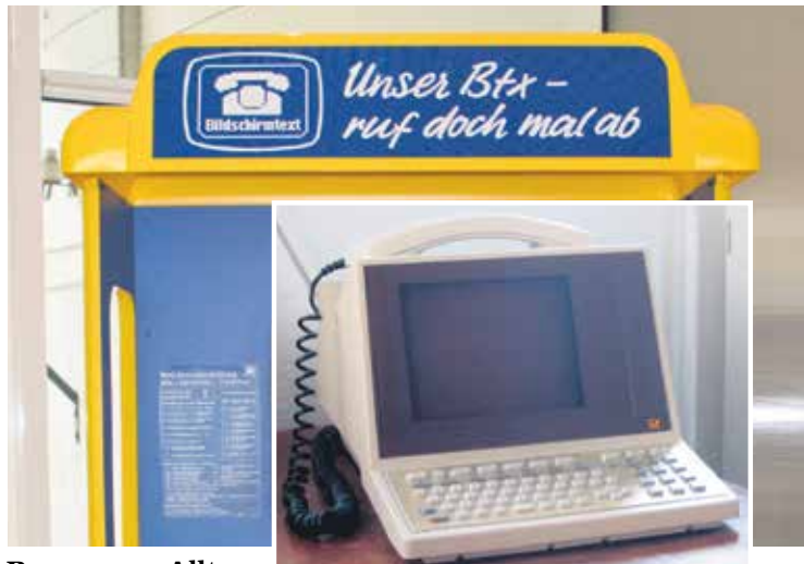
Bevor unser Alltag durch Handy und Internet bestimmt wurde, ging man per Bildschirmtext online. Hierfür gab es öffentliche Stationen oder Geräte für zu Hause.
